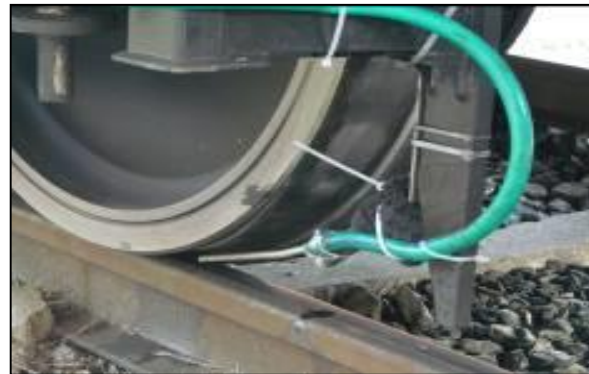
Gleitschutzversuche nach UIC 541-05
