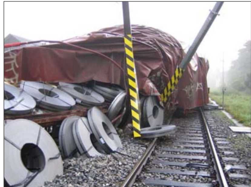
Einfahrt Bahnhof Kreuzlingen, 30.09.2006 Befund: Aufklettern durch Ladungsverschiebung
