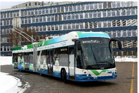
Charge en ligne - «In Motion Charging (IMC)»
