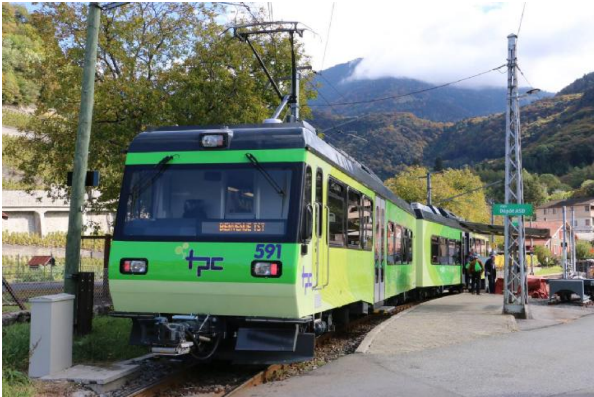
Le train spécial TST avec l'automotrice crémaillère double à Aigle Dépôt ASD.
