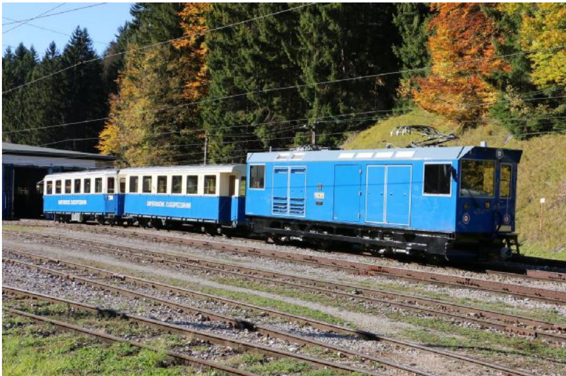
La locomotive crémillère Zugspitzbahn à quatre essieux achetée pour le renouvellement du télécabine.
