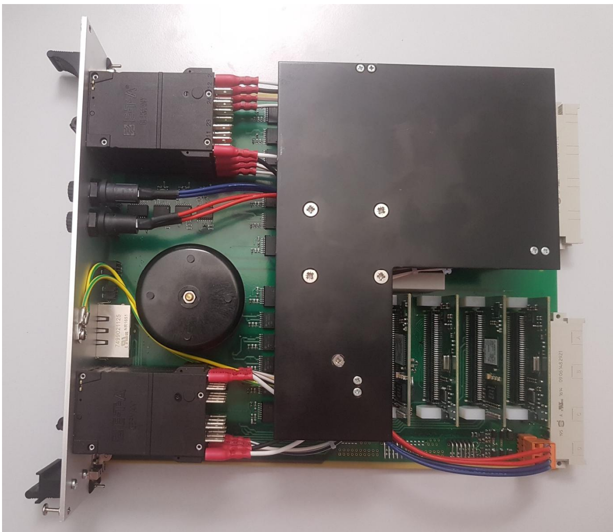
Abb. 21: Interface IPM 4-D 400: Aufbau der Baugruppe
