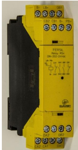
Abb. 42: Sicherheitsrelais FERSIL zur Ansteuerung des ZST-90
