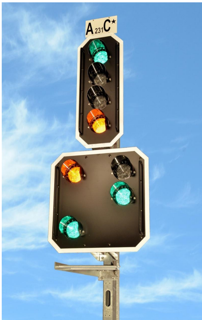
Fig. 65: Signaux principaux et avancés (signalisation L)
