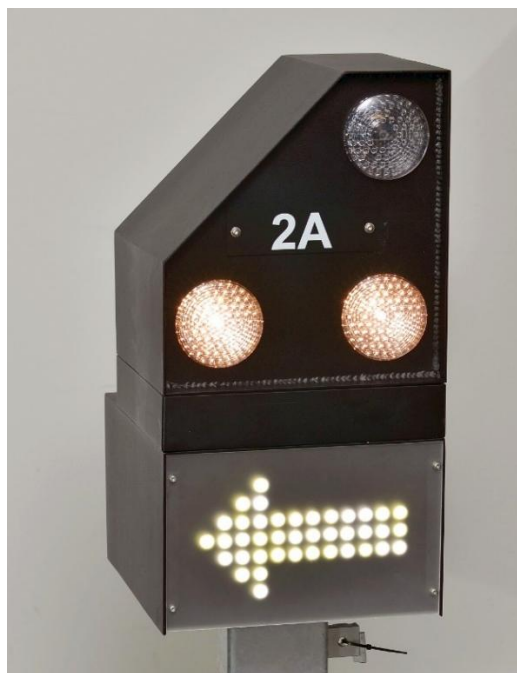
Fig. 67: à droite : Signal nain en placement à droite, avec flèche de direction
