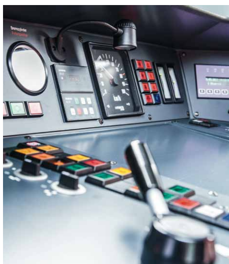
Clair et compact: l'appareil de commande et d'affichage du Trainguard ZSI 127 intégré dans le véhicule.
