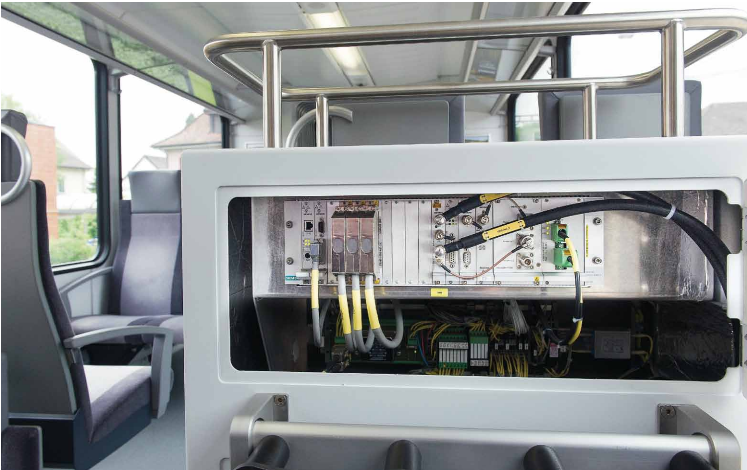
Platzsparender Einbau des ZSI 127-Fahrzeugrechners in den Fahrgastraum.
