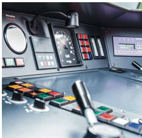
Übersichtlich und kompakt: das im Fahrzeug integrierte Bedien- und Anzeigergerät des Trainguard ZSI 127.
