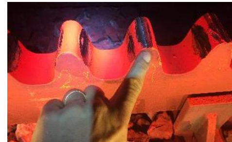
Horizontalkraftmessung an Rollenbalken F_{xR}
