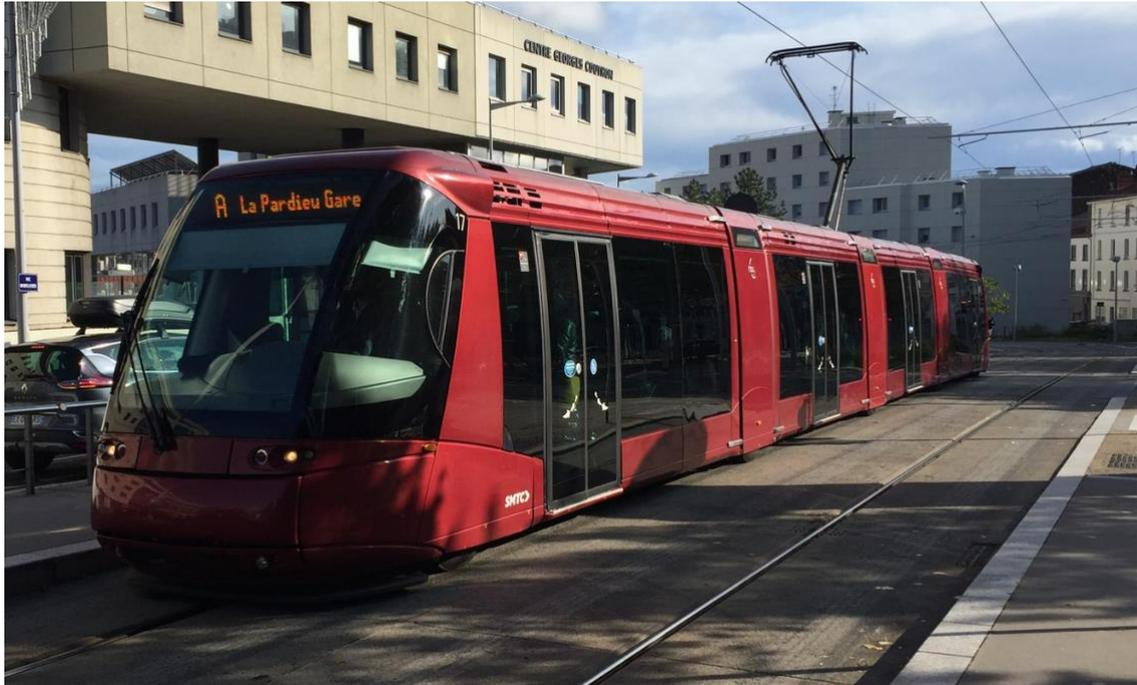
Die Spurführung erfolgt durch zwei schräggestellte Räder mit Spurkranz, die im 90°-Winkel zueinander stehen und seitlich in die Führungsschiene eingreifen. Die Fahrzeuge fahren mit 750 Volt Gleichstrom unter einer einpoligen Oberleitung und besitzen je einen Einholmstromabnehmer, der Rückstrom fliesst über die Führungsschiene.
