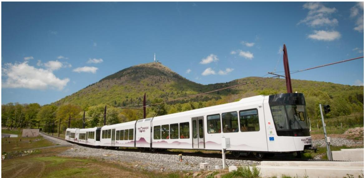
Die Spurweite der Strecke beträgt 1000 Millimeter. Es werden Y-Schwellen mit einer Zahnstange Typ Strub TN 70 eingesetzt. Diese relativ neu entwickelte Zahnstange wurde genauso wie die Schienen lückenlos verschweisst. Der kleinste Radius beträgt 70 Meter, die grösste Neigung 155 ‰. Die Bahn ist mit 1500 Volt Gleichstrom elektrifiziert.
