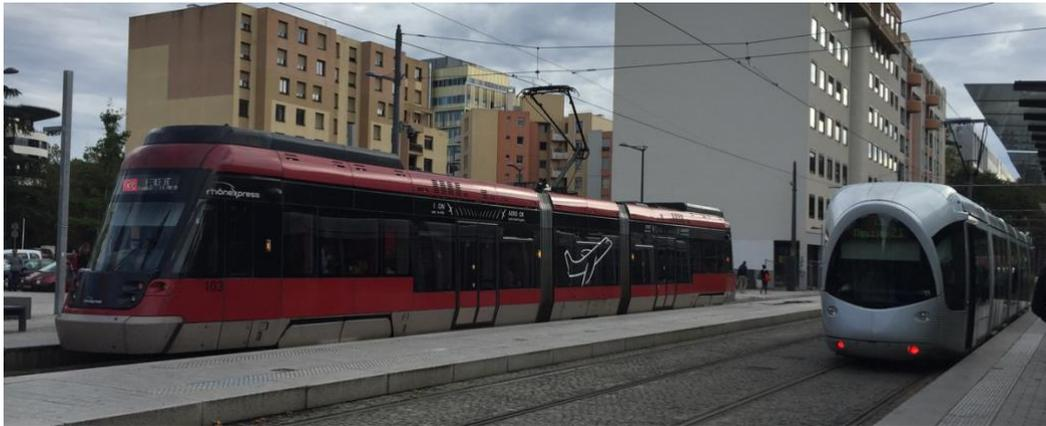
Es kommen sechs teilniederflurige Triebwagen vom Typ Stadler Tango mit einer Höchstgeschwindigkeit von 100 km/h zum Einsatz; die ersten beiden Triebwagen wurden im Dezember 2009 ausgeliefert. Die Triebwagen sind mit Informationsdisplays mit den Abflugs- und Ankunftszeiten, Steckdosen und Abstellbereichen für Gepäck ausgerüstet, den Fahrgästen steht ein Zugbegleiter zur Verfügung.
