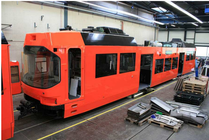
Révision et mise à niveau d'un train régional dans l'atelier Worbboden. (Photo Th. Stolz)
