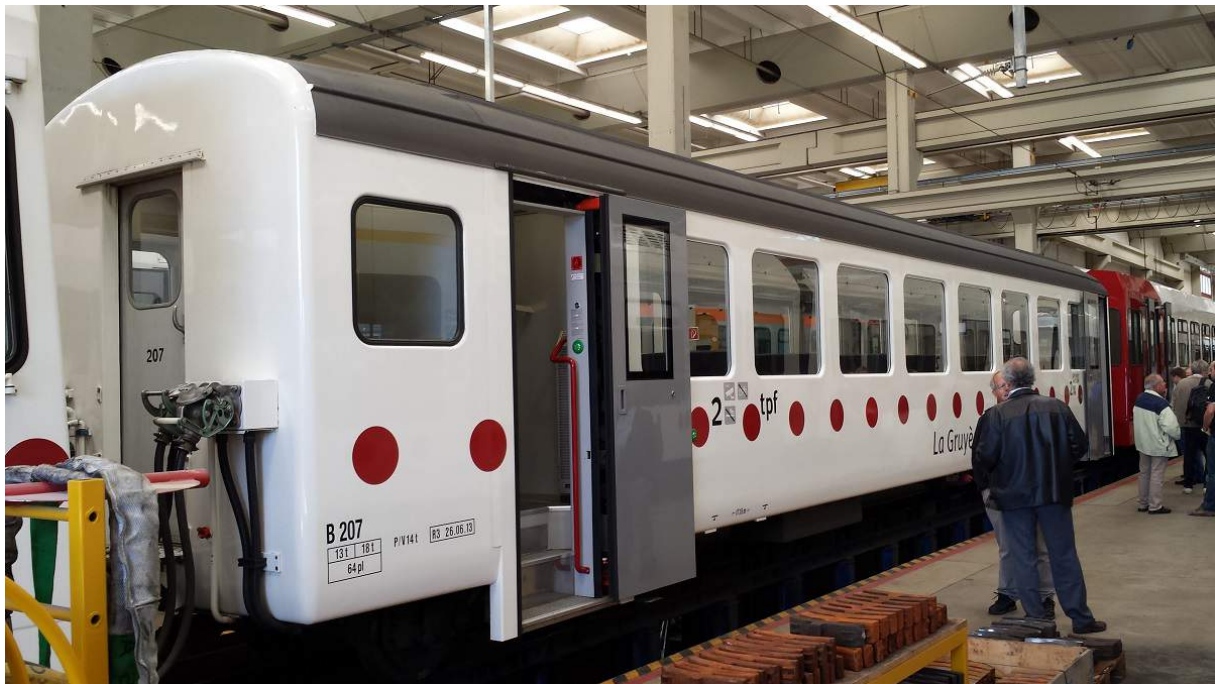
Ehemaliger Goldenpass-Zwischenwagen, der in der eigenen Werkstätte Bulle Planchy für den tpf-Einsatz mit neuen, aussenbündigen Türen ausgerüstet wurde.
