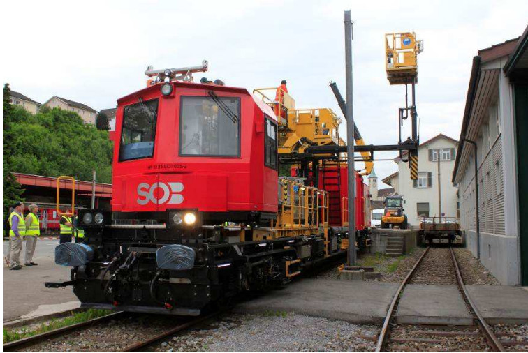
Eines der beiden Mehrzweckfahrzeuge für den Unterhalt der Infrastruktur anlässlich der Vorstellung in Herisau (Foto Th. Stolz).
