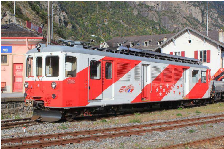
Aus einem Personenzahnradtriebswagen umgebaut-es Zweikraftdienstfahrzeug (Foto Th. Stolz).
