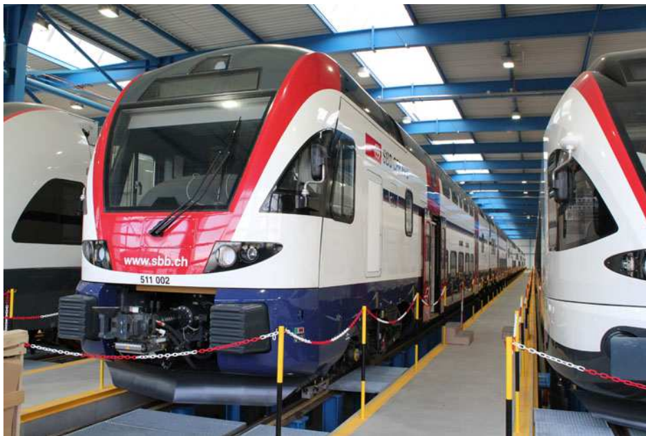
Stadler construit pour le RER de Zurich 50 trains à deux étages du type KISS à six caisses et pour le trafic régional des CFF 24 trains à deux étages à quatre caisses (Foto Th. Stolz).
