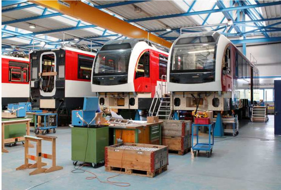
Les premiers trains pour la Zentralbahn seront livrés en août 2012. La livraison comprend au total quatre trains à sept caisses et six trains à trois caisses comportant une traction répartie entre adhésion et crémaillère (Foto Th. Stolz).
