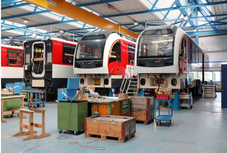
Die ersten neuen Züge der Zentralbahn werden Anfang 2012 ausgeliefert. Insgesamt werden von Stadler vier siebenteilige und sechs dreiteilige Zahnradzüge mit aufgeteiltem Adhäsions- und Zahnradantrieb geliefert (Foto Th. Stolz).
