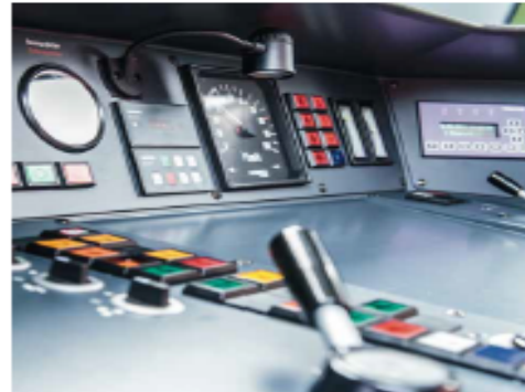
Obersichtlich und kompakt: das im Fahrzeug integrierte Bedien- und Anzeigegerät des Trainguard ZSI 127.
