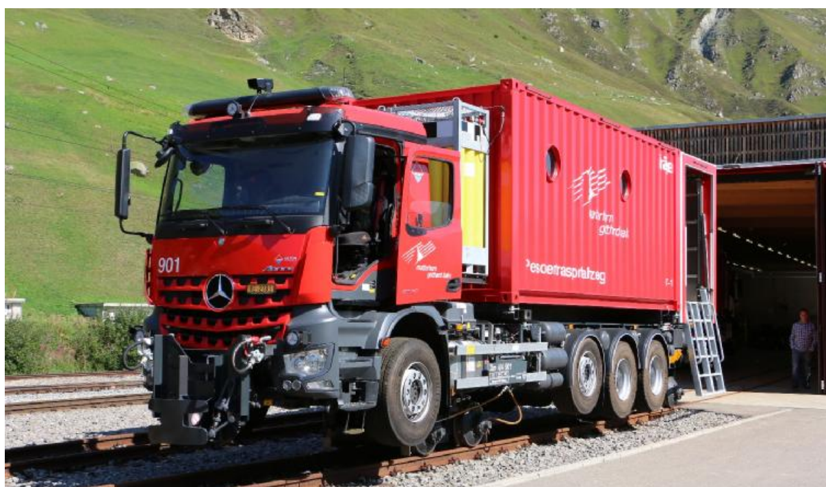
Camion bi-mode du service de sauvetage avec container amovible devant le bâtiment d'intervention à Realp.
