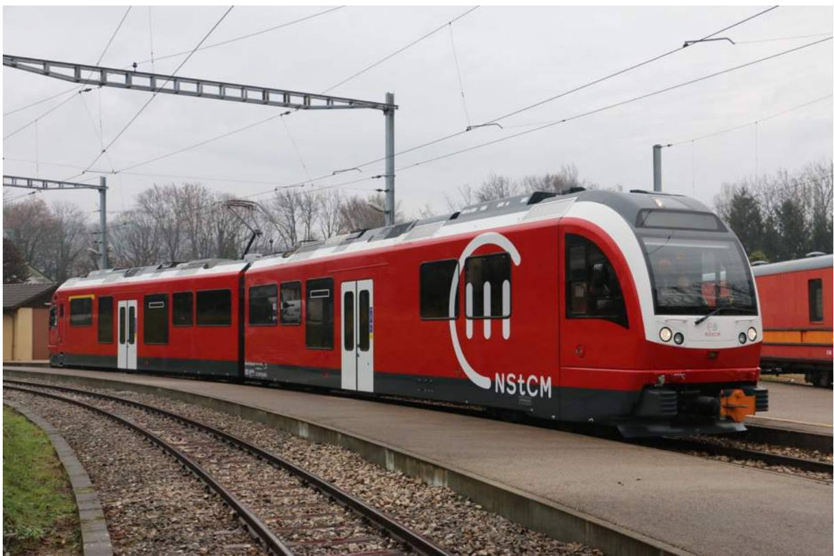
Bei der NStCM sind zwei Triebwagen fest gekuppelt. Bei Bedarf könnte ein Zwischenwagen eingereiht werden.
