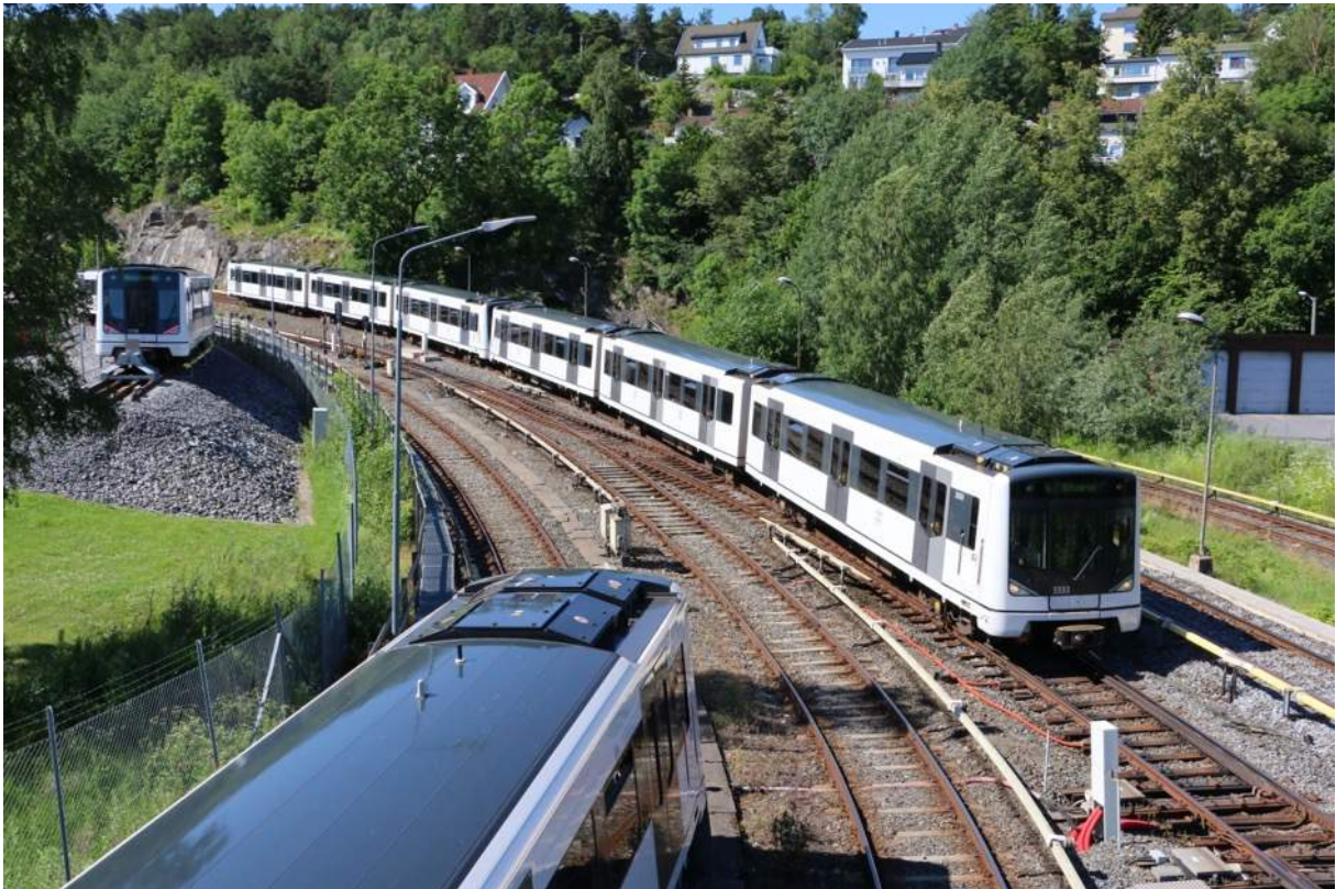
Die U-Bahnzüge in Oslo sind dreiteilige Einheiten, die entweder einzeln oder in Doppeltraktion verkehren.
