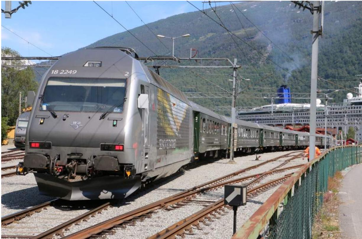
*Les locomotives qui ne sont plus utilisées en trafic de longue distance sont maintenant en service sur le Flâm-Bahn. Une composition avec une locomotive à chaque bout est utilisée en service pendulaire et il ne nécessite plus de manœuvre.*
