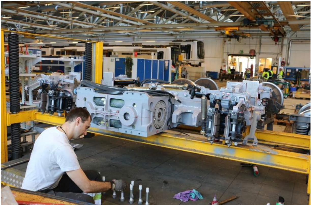
*Un bogie du tramway à plancher bas en révision dans l'atelier du métro.*
