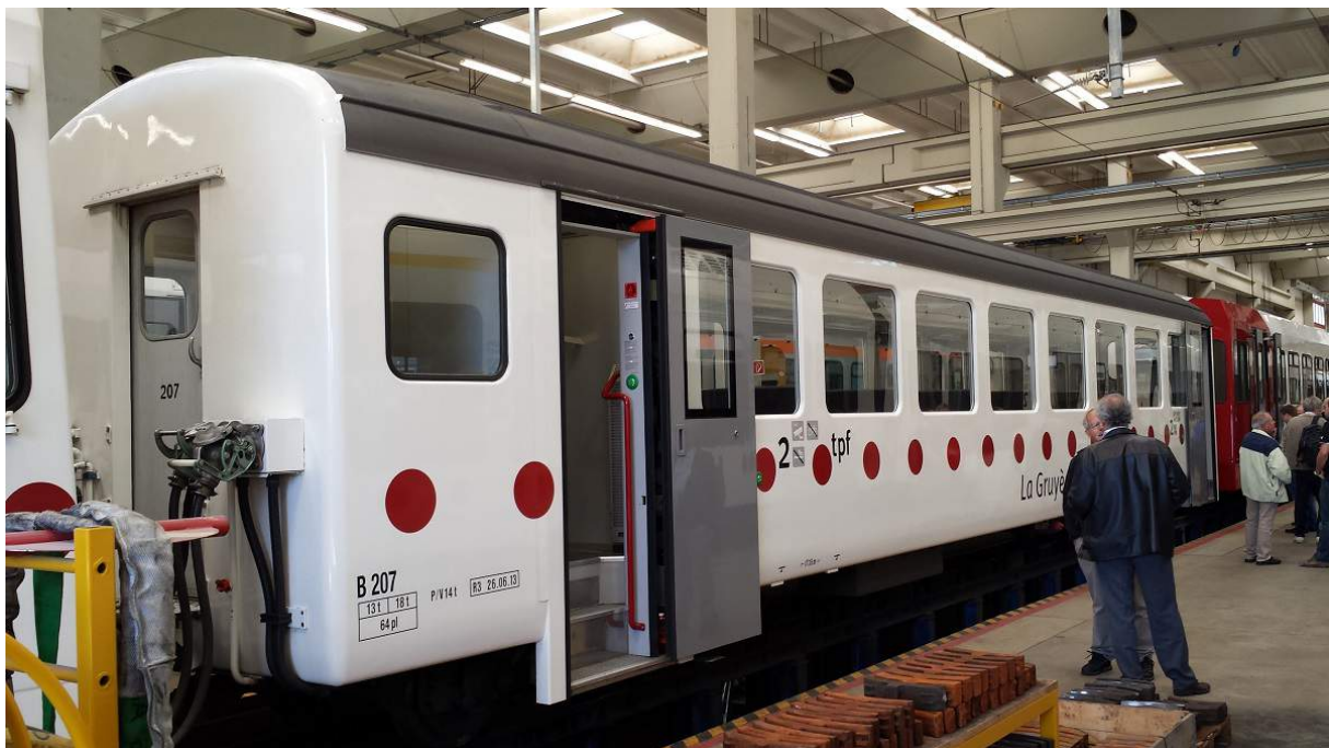
Ancienne voiture intermédiaire du Goldenpass, équipé dans l'atelier Planchy à Bulle par des nouvelles portes affleurantes pour l'exploitation par les tpf.
