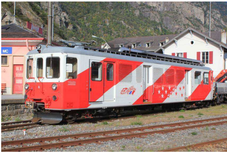
Ancienne automotrice crémaillère transformée en véhicule de service bi-mode (Foto Th. Stolz).
