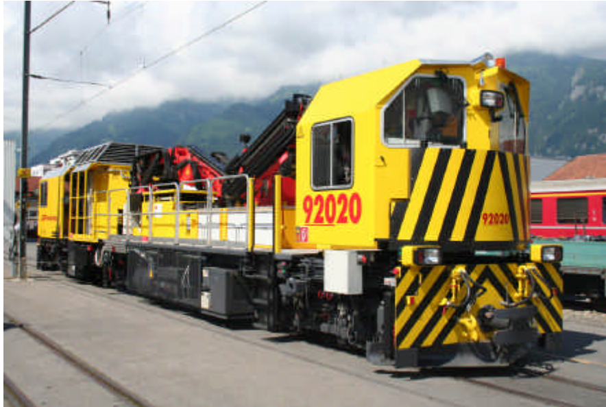
Nouveau véhicule de maintenance de la ligne de contact à six essieux à Landquart (Th. Stolz).
