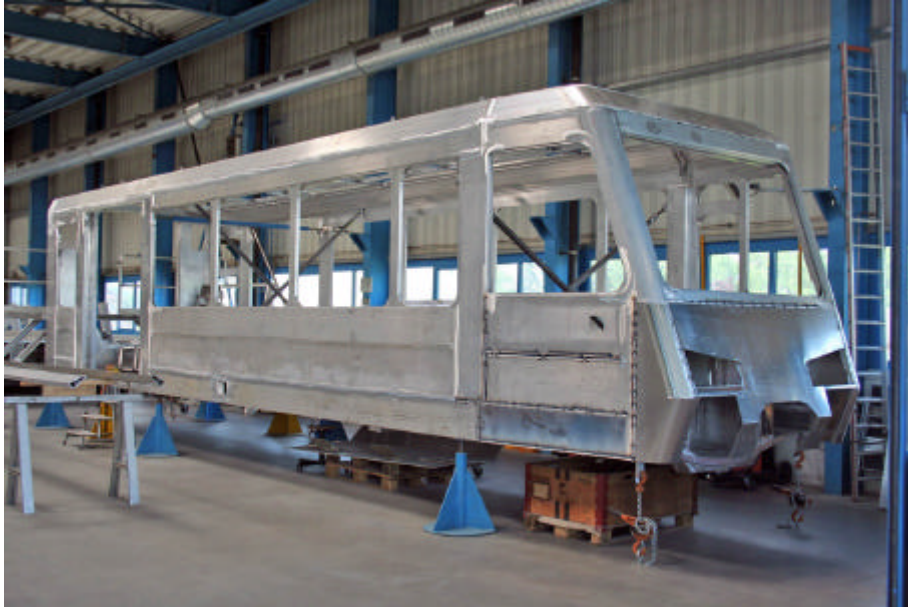
Für die SNCF-Meterspurstrecke in Chamonix baut Stadler sechs Panoramatriebwagen. Hier steht ein Endwagen kurz vor Fertigstellung des Rohbaus.
